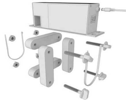
1. Insérer les ferrites dans l'ouverture prévue à cet effet d chaque côté à l'aide des vis.
