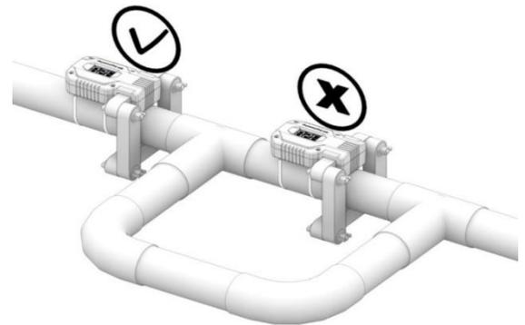
S'il y a un "circuit électrique", il y a une connexion métallique devant et derrière l'appareil. La tension est interrompue (court-circuit). Trouvez un endroit approprié devant ou derrière le circuit éventuel et remontez l'appareil. Respectez les instructions d'installation ci-jointes.
